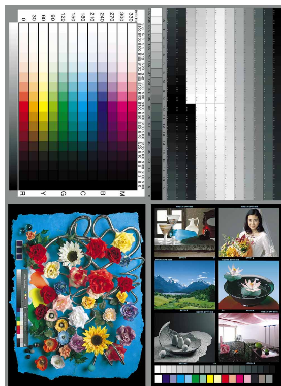
基本変換設定で変換したデータ トーンカーブでシアン版を強めにして赤み をキャンセルしている。
