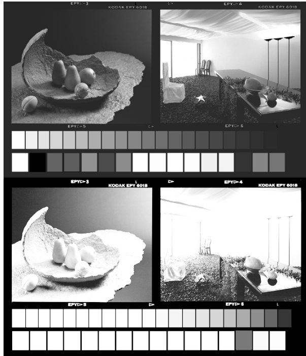
GCR(軟調)で変換したC版(上)と墨版(下)
